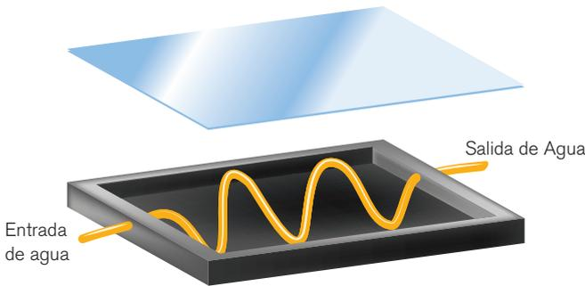
Esquema básico de un calentador solar.
